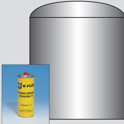
Выполните изоляцию стенок резервуара. Вначале измерьте периметр резервуара, используя полоску материала "K-FLEX" той же толщины, что и применяемая изоляция. Не растягивайте полоску при измерении. Затем определите высоту стенок металлической емкости.
