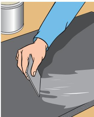
Используйте гибкий шпатель при нанесении kleя "K-FLEX" на большие поверхности. Если Вы приклеиваете материал "K-FLEX" по всей площади, вначале нанесите kleй на изоляционный материал, а затем на поверхность. Когда kleй достаточно просохнет, наложите лист на поверхность и сильно прижмите на короткое время.
