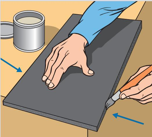
4 Нанесите ровный слой клея "K-FLEX" на подлежащие склеиванию торцы листовой изоляции.
