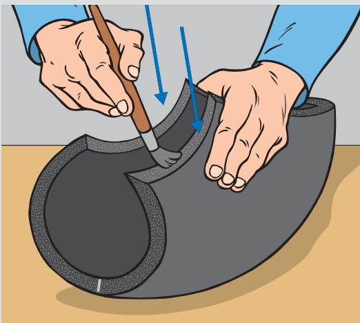
**3** После того, как клей подсохнет, поместите изоляционный угол на изгиб трубопровода.
