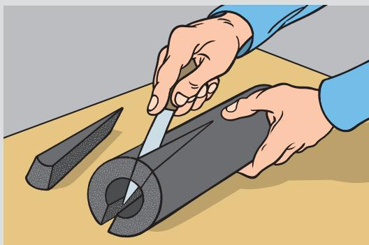
Нанесите клей на края V-образных вырезов. Дайте kleю подсохнуть, затем соедините края и сильно сожмите на очень короткое время.
