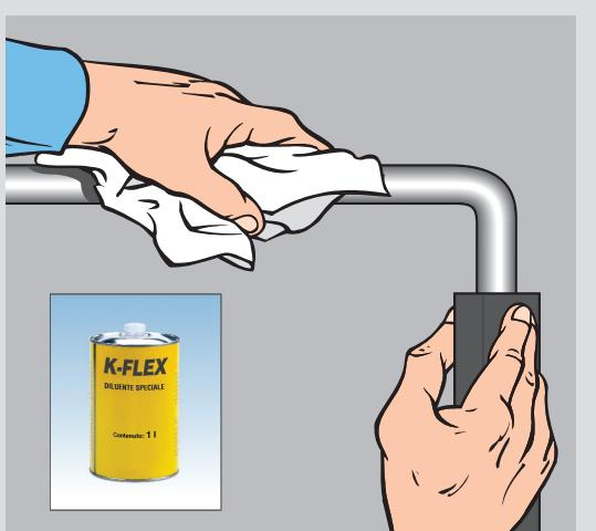
1 Изолируемые поверхности должны быть сухими, чистыми и обезжиренными. Очистите их с помощью очистителя "K-FLEX".
